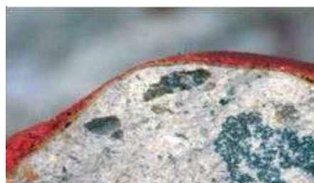
Nieprawidłowo: jednokrotne malowanie farbą oznacza zbyt małą grubość warstwy na ostrych krawędziach ziaren
