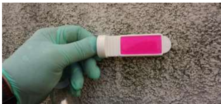
Próba odciskowa, pobór z powierzchni przegrody na zewnątrz budynku
