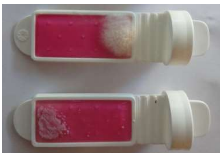
Kolonie grzybów pleśniowych, wyhodowane z prób z elewacji.
