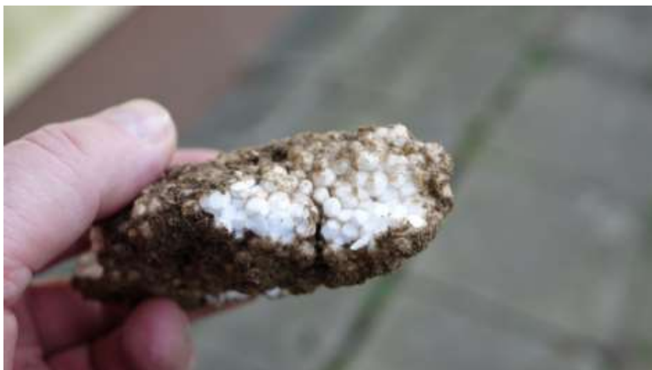
Docieplenie w strefie cokołowej jest wykonane ze styropianu. Należy je wymienić na wodoodporne – styrodur.
