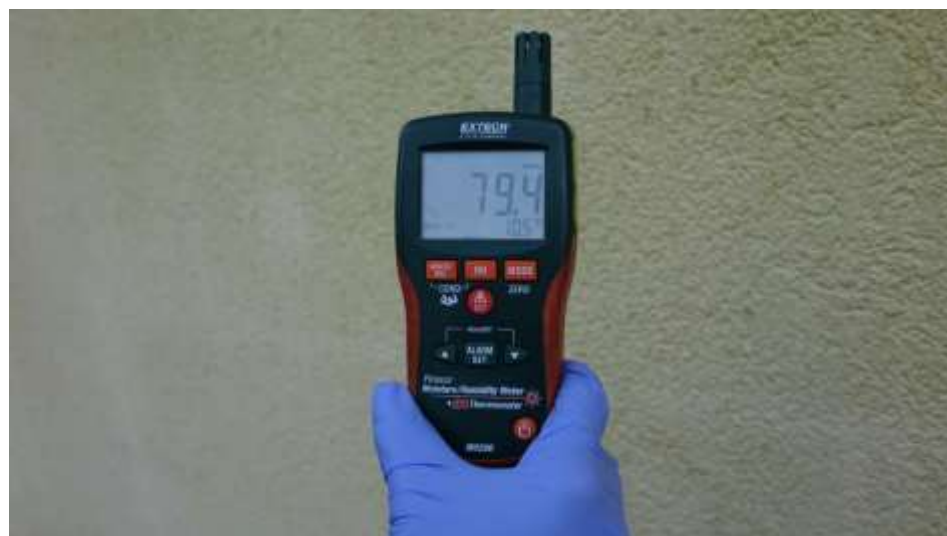
Warunki, w jakich wykonywano badania: wilgotność względna powietrza: 79,4 %, temperatura: 10,5 stopni Celsjusza. Są to warunki, sprzyjające pojawianiu się i rozwojowi mikroorganizmów
