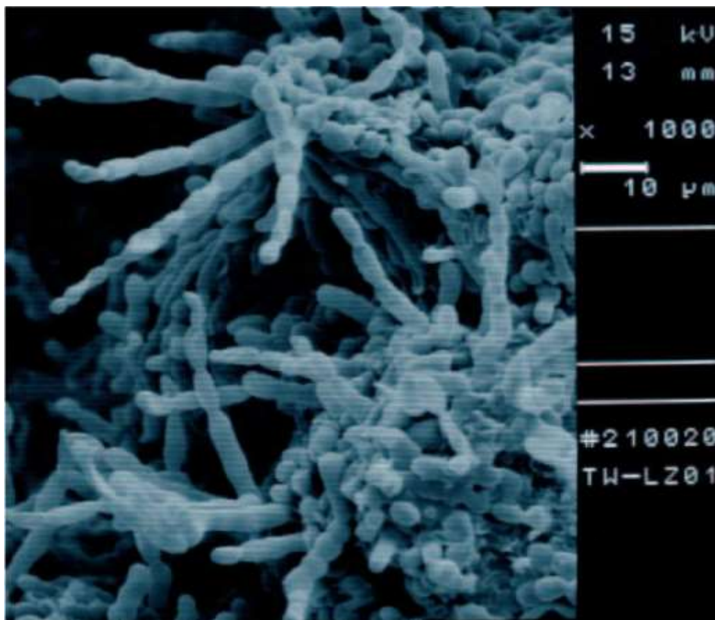
Typowy grzyb elewacyjny w 1000-krotnym powiększeniu pod mikroskopem
