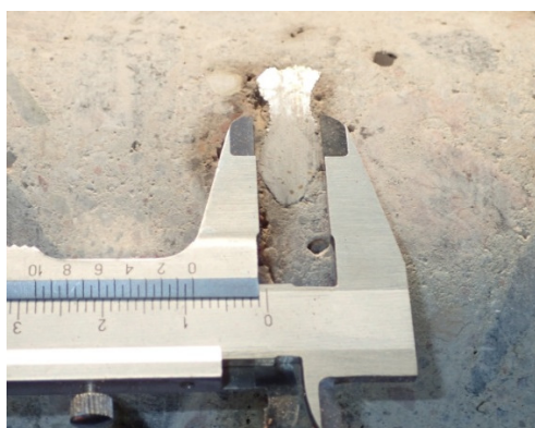
Fot. 3.1. Filar podpory nr 2. Pomiar bezpośredni średnicy zbrojenia na odwiercie OD 1 za pomocą suwmiarki. Średnica prętów zbrojenia wynosi ok. 8 mm.
