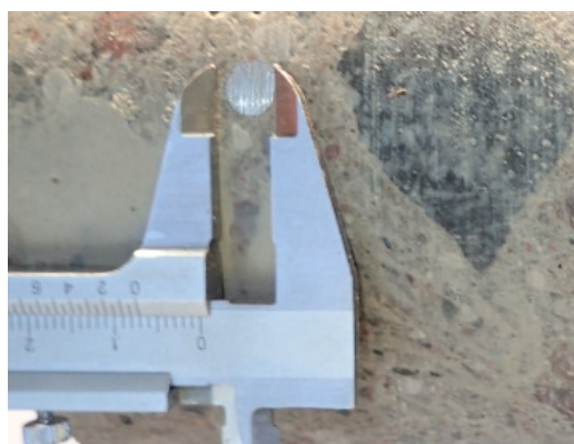
Fot. 3.1. Filar podpory nr 2. Pomiar bezpośredni średnicy zbrojenia na odwiercie OD 3 za pomocą suwmiarki. Średnica prętów zbrojenia wynosi ok. 6 mm.
